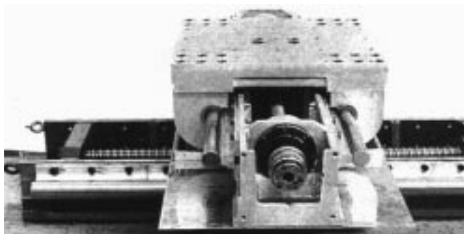
Figure n°7: Unité de chariot en fonte de titane et d'aluminium
